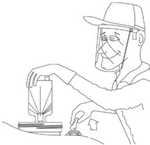
4. Posicione o frasco sobre o lavador de embalagens e acione a alavanca da válvula direcional a fim de efetuar a limpeza interna do frasco.
