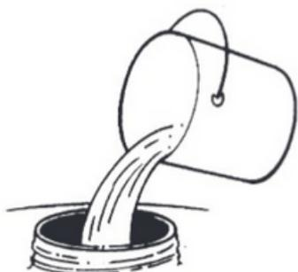
Adicione a calda preparada no depósito. Monte a tampa do depósito e certifique-se de que não há vazamentos.
