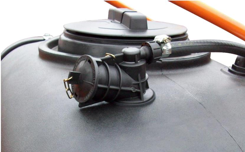
Figura 5- Detalhe do Reabastecedor e Tampa de Abastecimento
