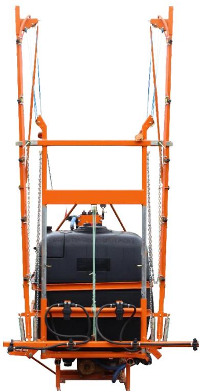
Figura 9- Pulverizador com Barra Fechadas e Travadas
