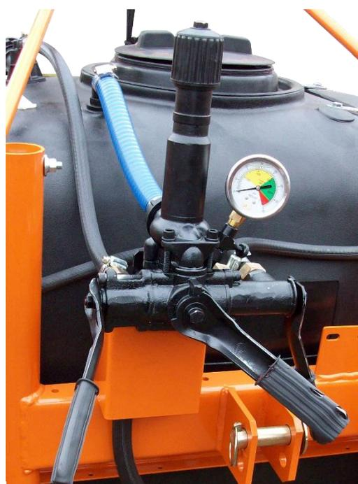
Figura 3 - Comando VAR 2 Vias com Reabastecedor Integrado
