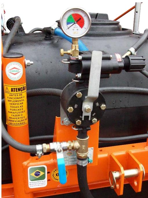
Figura 4 - Comando PEC com Reabastecedor Externo
