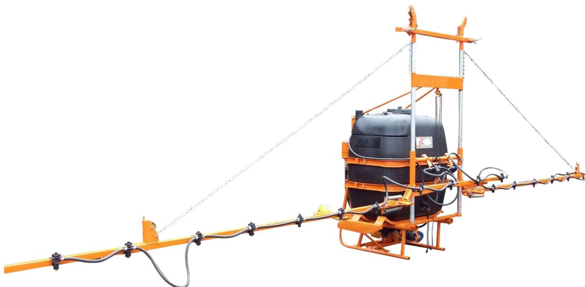
Figura 10 - Pulverizador com Barras Aberta e Alinhadas
