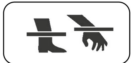
Não coloque mãos ou pés sob o chassi. O contato com as facas podem causar ferimentos graves ou morte.
