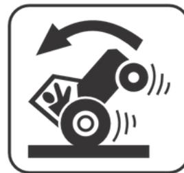
Não trabalhe com o trator se a frente estiver sem lastro suficiente para o equipamento traseiro. Havendo tendência para levantar, adicione pesos ou lastros na frente ou nas rodas dianteiras.
